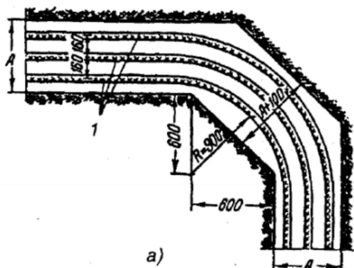
В готовой траншее кабель прокладывают, раскатывая его с барабана, установленного на кабельном транспортере, автомобиле или трубоукладчике, которые перемещаются вдоль траншеи. При этом принимают сматываемый кабель и укладывают его на дно. На трассах с большим количеством пересечений с
